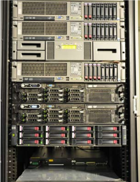
Figura 4: VTL del Data Center de la AUI. / Figure 4: Data Center's VTL
