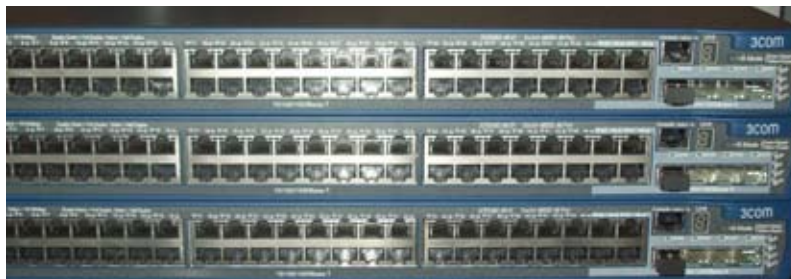
Figura 18: equipos de conmutación de paquetes: Switch layer 3 / Figure 18: Packet Switching Equipment: Switch 3-Layer
